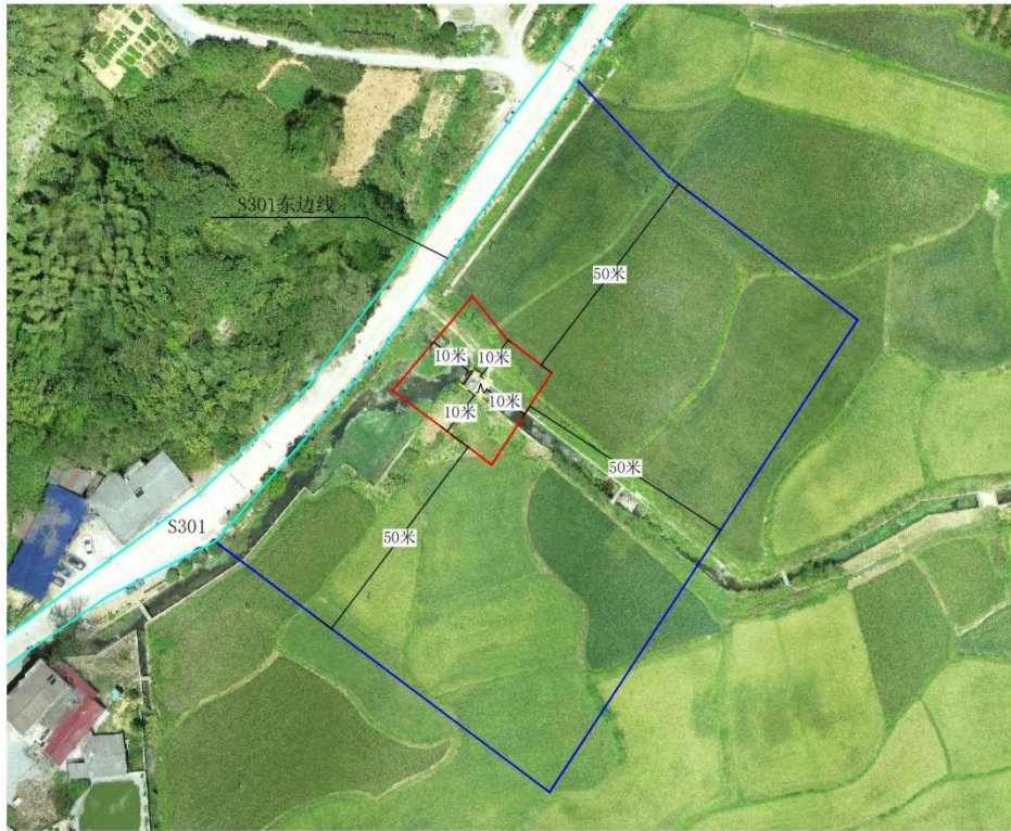
图2-18 云溪区汾水堰节制闸管理与保护范围标绘示意图
